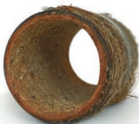
ohne Schutz, verrostetes Heizungsrohr mit Magnetitablagerungen
